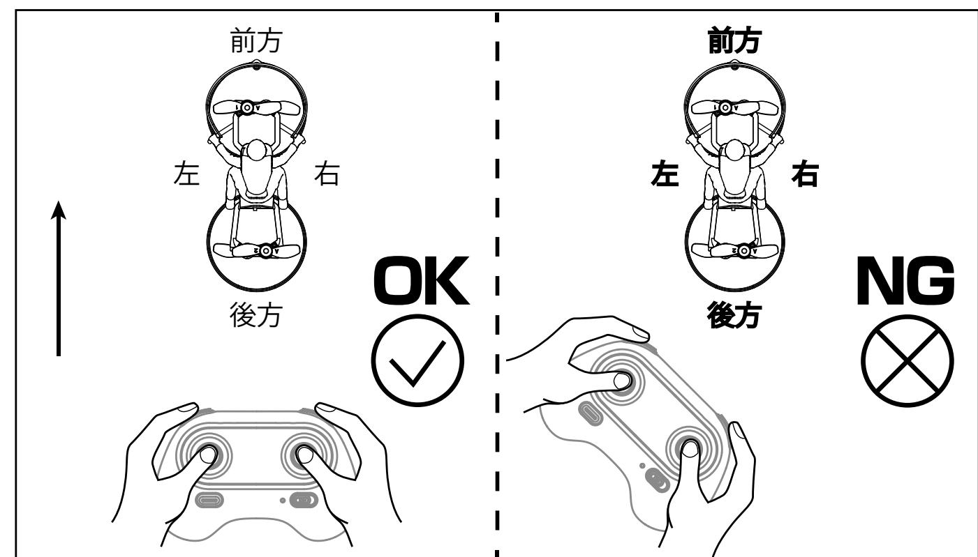
進行方向固定モードボタンを押すと、コントローラーが「ピッピッ」と鳴り、ドローンが進行方向固定モードになります。
