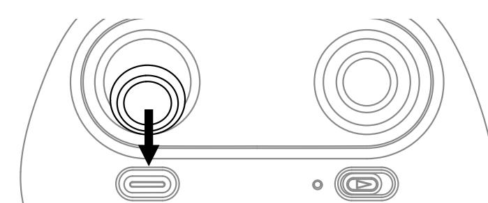
※同時に同じ場所で複数台のペアリング操作を行うと、混信の可能性があります。一台ずつペアリングを完了させてください。ペアリングに失敗した場合は、ペアリングを再度やり直してください。
