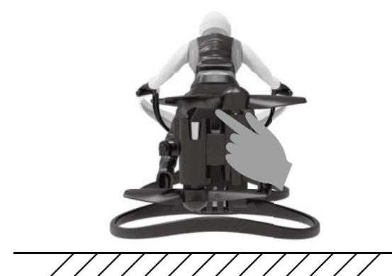
※必ずドローンを水平面に置いてペアリングしてください。
