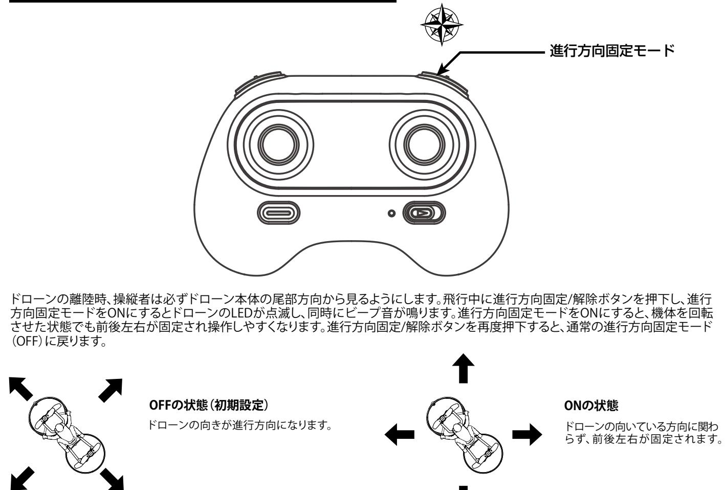
注意: ドローンの動作が安定する前に、進行方向固定モードを使用しないでください。
