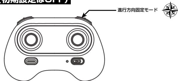
ドローンの離陸時、操縦者は必ずドローン本体の尾部方向から見るようにします。飛行中に進行方向固定/解除ボタンを押下し、進行方向固定モードをONにするとドローンのLEDが点滅し、同時にビープ音が鳴ります。進行方向固定モードをONにすると、機体を回転させた状態でも前後左右が固定され操作しやすくなります。進行方向固定/解除ボタンを再度押下すると、通常の進行方向固定モード(OFF)に戻ります。
