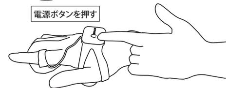
**【緊急停止】** ドローンが飛行中に緊急事態が発生した場合には、電源ボタンを1秒間長押しすると、すぐにモーターを停止させることが出来ます。非常時に、怪我や破損などの状況避けるために使用します。
